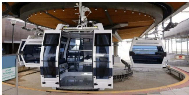
Рис. Пример выполнения конечной станции кольцевого канатной дороги кабинного типа с неотцепляемыми кабинами
