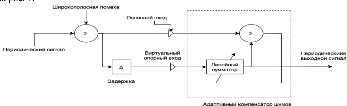
Рис. 1. Структурная схема адаптивного подавителя помех с виртуальным опорным входом
